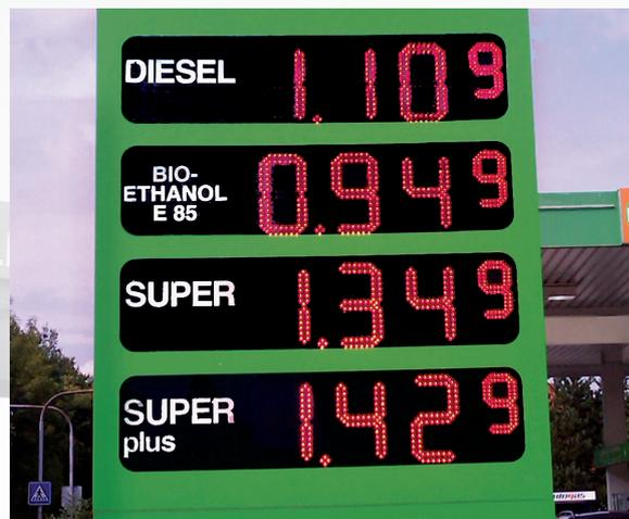
Die technische Entwicklung der Beleuchtungen der Preisanzeigenmasten macht sich auch an der Tankstelle bemerkbar. Seit 2011 werden Preisanzeigen de facto nur noch mit LED-Lampen ausgerüstet. Das erhöht die Sichtbarkeit, spart Stromkosten und ist weniger wartungsanfällig. Denn im Gegensatz zu elektromagnetischen Anzeigen sind LED-Anzeigen absolut wartungsfrei, ein „Hängenbleiben“ von einzelnen Segmenten ist ausgeschlossen.
